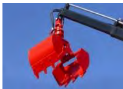
Grue avec treuil / rotator / benne preneuse
