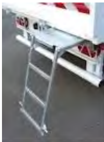
Escalier sous benne
