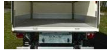
Aménagements lavable (plancher alu polyurée, plinthes alu, bonde évacuation, ventilation)
