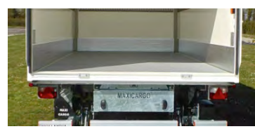
Aménagements lavable (plancher alu polyurée, plinthes alu, bonde évacuation, ventilation)
