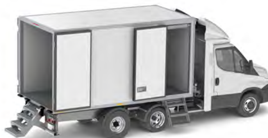
Exemple configuration n°6 Bi-température escalier
