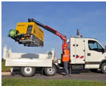
Grue en dos cabine pour les grosses charges
