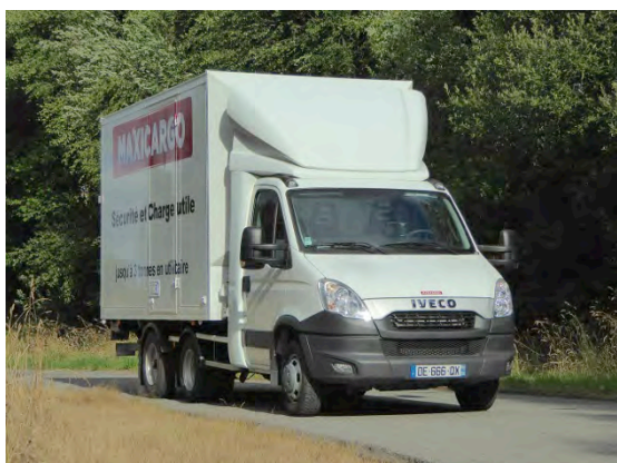
Déflecteurs d'air cabine et latéraux anti-vortex
